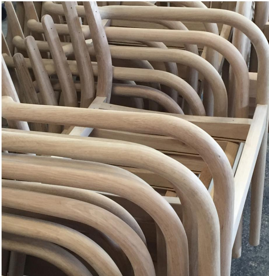
und Fräsen, begonnen werden. Zuletzt schleifen spezialisierte Mitarbeiter das Holz von Hand und verleihen ihm geduldig seine weiche handfreundliche Haptik. Dann werden die fertig bearbeiteten Einzelteile zusammengefügt; verzapft, verleimt und verpresst. Jedes Holzgestell wird schlussendlich nochmals genau kontrolliert und von Hand verputzt.
